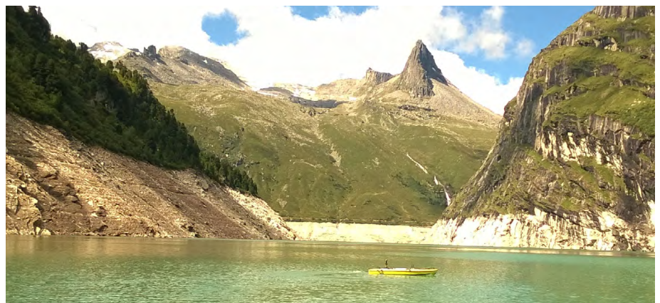
Abb. 1: Echolot-Aufnahmen mit Modellboot, Stausee Zervreila.
